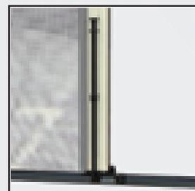
Particolare ferma anta inferiore con guida bassa da 16 mm.
